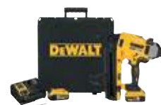
DCN890P2 Clavadora de Hormigón sin escobillas XR 18V para clavos 15° de 2,6-3,7mm diámetro y 13-57mm largo con 2 baterías Li-Ion 5,0Ah, cargador, 2 puntas de contacto y maletín.
