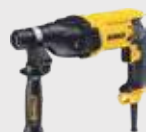
DT25133K Martillo Ligero Combinado 800W 3 Modos - 26mm 2,6J - SDS-Plus - P.Pistola. Incluye maletín TSTAK.
