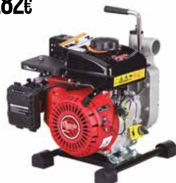
Motobomba gasolina Campeón 4t Motor 4 temps, 80 cc. 1.7 kw. Cabal màx. 15.000 l/h. Altura màx. 20 m. Auto-aspirant 5 m. Inclou 2 Conjunts de racors. Norma EUR2. 1247X11
