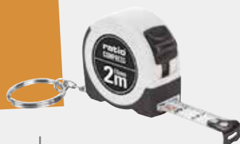
Flexòmetre clauer Ratio Compress 2 m Cinta 13 mm antireflex. Ganxo metàl·lic i botó de bloqueig. 4613H2
