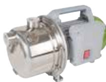
Bomba autoaspirant Lista Hidromat 900 BS 900 W. Cabal màx. 60 l/min. Altura màx. 42 m. Profunditat màx. 8 m. 1246X900B
