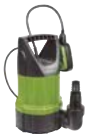
Aigües netes Lista AL-116 400 W. Cabal màx. 116 l/min. Altura màx. 7.5 m. Profunditat màx. 7 m. Cable 10 m. 7993X411
